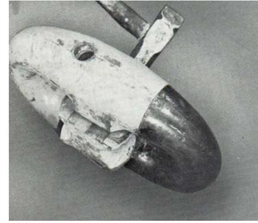
3) una volta estratta la spina, usando il martello sfilare il traversino
