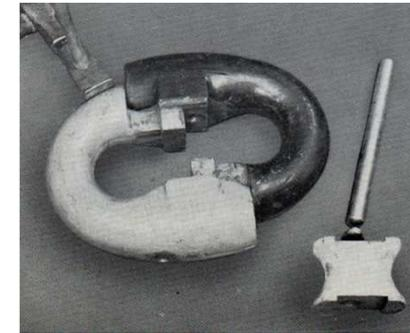
4) usando il martello battere sulla spalla della maglia kenter, lato corto, fino a smontare le due semimaglie
